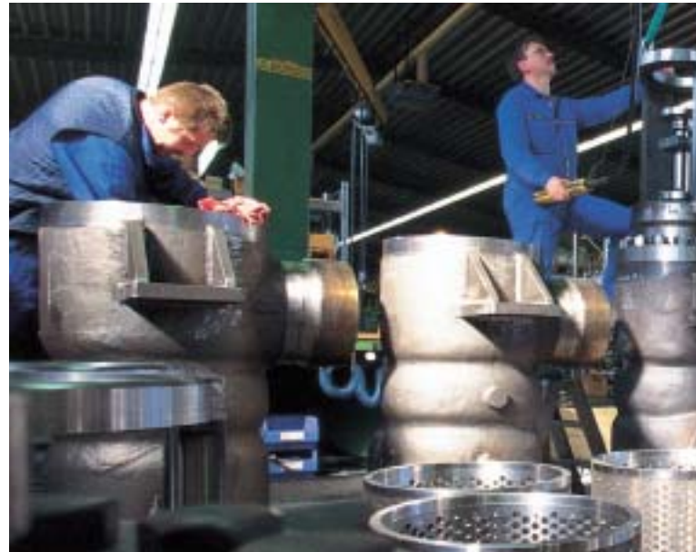
Die Montage und Prüfung der tonnenschweren Industriearmaturen erfordern Millimeterarbeit und Fingerspitzengefühl.
